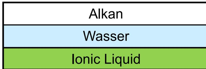
Dreiphasensystem mit einer gezielten Nichtlöslichkeit der ionischen Flüssigkeit in Wasser
